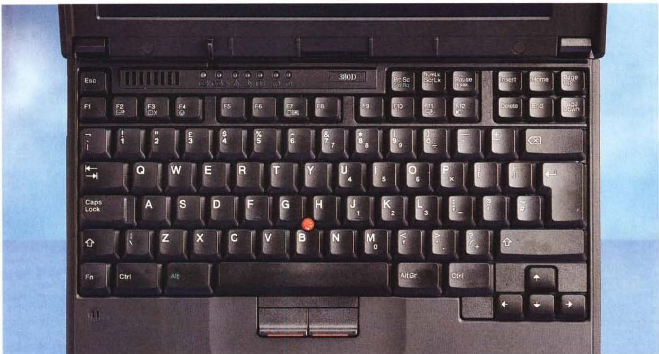
La tastiera del ThinkPad è completa e bene organizzata. Immane il simpatico dispositivo di puntamento TrackPoint III tipico di queste macchine.
